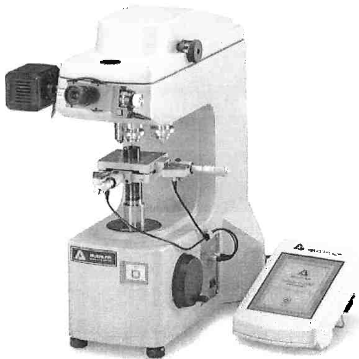
Figura 4.10 - Aparelho utilizado para medidas de microdureza
