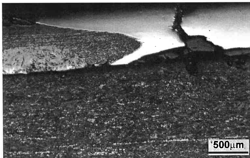
Figura 5.13 - Fratura no aço inox próxima a interface tripla da chapa 6. Imagem em microscópio óptico; Ataque Nital 5% 10s; Aumento de 32x;
