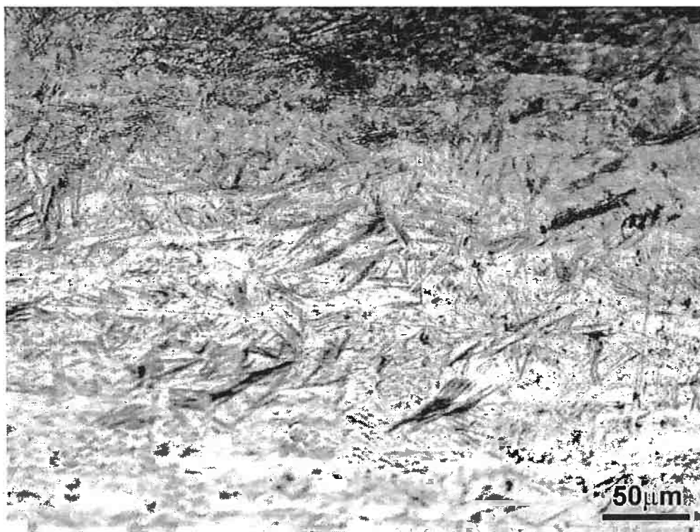
Figura 5.6 - Foto em microscópio óptico que mostra a microestrutura do aço D6A depois da laminação próxima a superfície; Amostra A3 atacada com Nital 5%;
