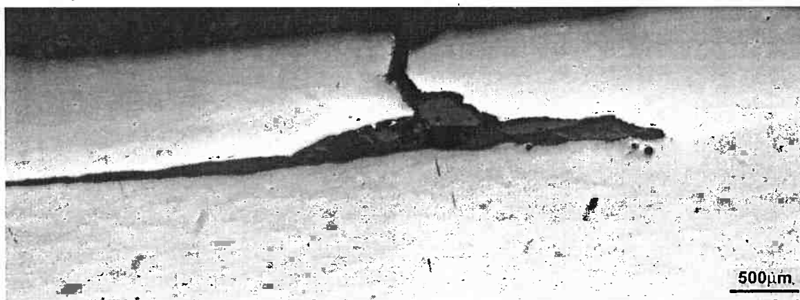
Figura 5.12 - Contaminação atípica na chapa 6; Amostra p6 sem ataque metalográfico; Aumento de 32x.
