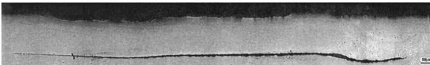
Figura 5.8 - Foto em microscópio óptico que mostra uma montagem realizada para a amostra p5 com algumas fotos em microscópio óptico com aumento de 32x. A régua na base da imagem indica um comprimento de 500 \mu m. Amostra sem ataque metalográfico.
