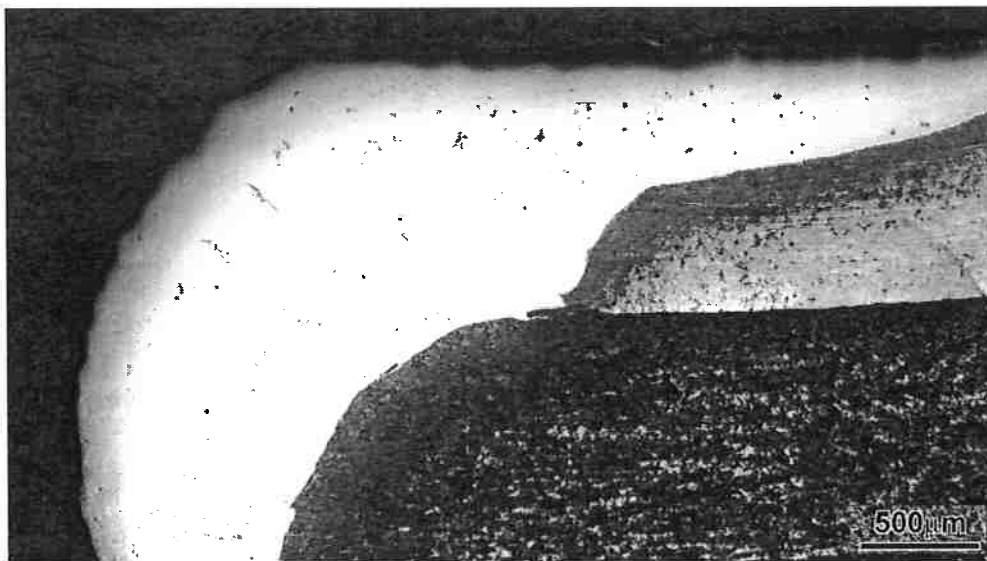
Figura 5.14 - Interface tripla na borda esquerda da chapa 4; Ataque com nital 5% por 10s; Aumento de 32x.
